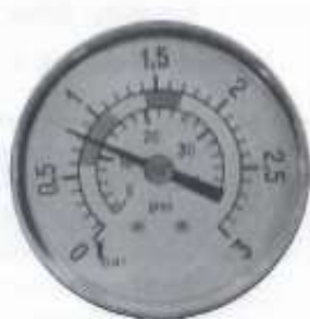
0,8 kg/cm 2 (11,4 PSI) Tlak na začiatku filtračného cyklu
